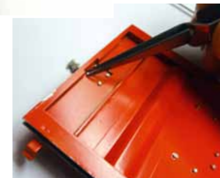
Zum Aufsetzen der Muttern in M1 braucht es eine Pinzette und ein ruhiges Händchen
