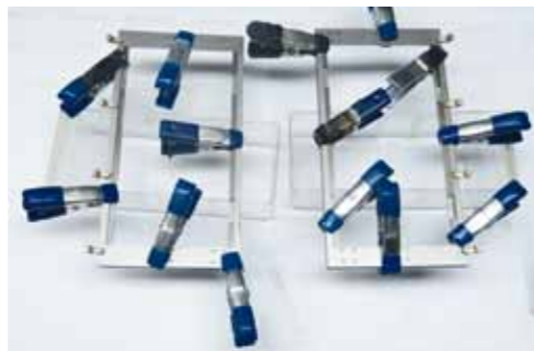
Selbst das Zusammenkleben der einzelnen Türsegmente verlangt nicht nur eine Menge Klammern, sondern auch ebenso viel Fingerspitzengefühl
